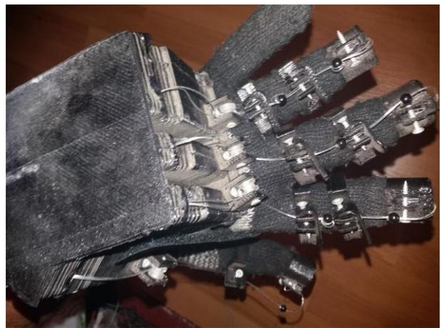
Figure 8 : The actual glove feedback mechanism
