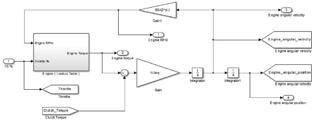
Fig. 2. Engine Subsystem Block
